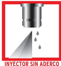
Una mala atomización del gasoil provoca una disminución del rendimiento, más emisiones y exceso de consumo con elevados costes de mantenimiento
