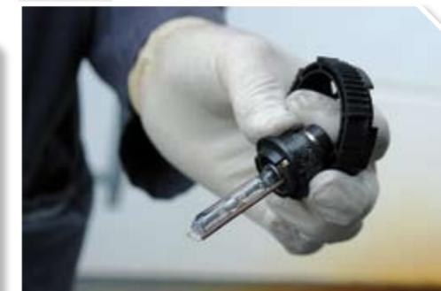
5 Sacar la lámpara según la orientación del faro y sustituirla por una nueva.
