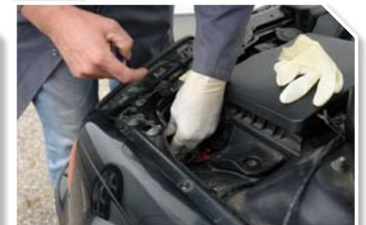
6 Comprobar que los cables estén bien conectados con la lámpara. Colocar la tapa de los faros.
