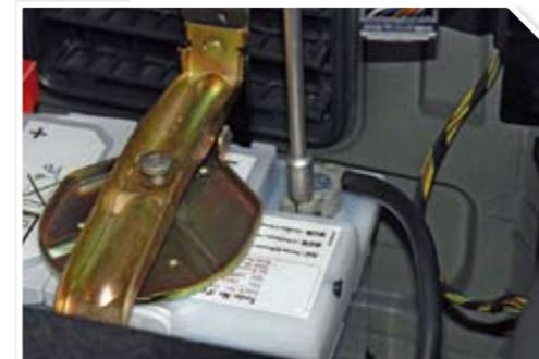
7 Colocar de nuevo la borna negativa en la batería y la clema en el balasto.
