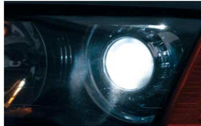
XENARC® de OSRAM, entren en funcionamiento, es necesario un encendido a alto voltaje. Tocar cualquier pieza bajo corriente de la lámpara o el balasto puede llegar a causar la muerte por descarga eléctrica. Por ello, se debe desconectar la corriente del balasto e incluso la batería del coche.
