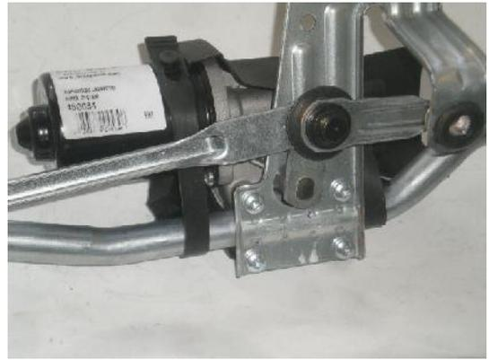
4) Desmontar las varillas de empuje.
