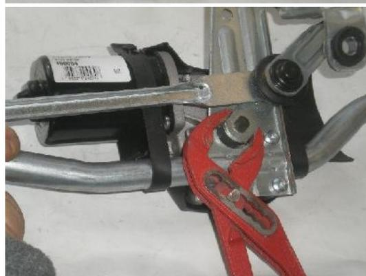
3) Gire la palanca de salida hasta que los cuatro tornillos estén visibles
